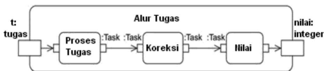
Gambar 6.18 Contoh sebuah Node Objek dalam notasi Pin
